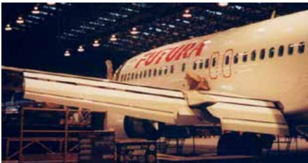
**Landeklappen bei einem Airliner**
